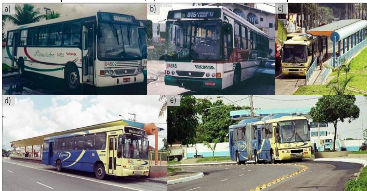
Figura 3 - Ônibus da Eucatur: a) ônibus convencional de linha alimentadora; b) ônibus padron de linha circular; c) plataforma de embarque único; d) ônibus convencional operando no corredor; e) ônibus articulado do sistema Expresso.
