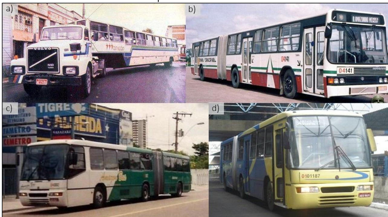
Figura 2 - Primeiro ônibus articulado da cidade de Manaus: a) e b) ônibus com sua primeira carroceria e que operou no sistema de transporte coletivo de Manaus entre 1991 e 1999; c) e d) chassi reencarroçado com a retirada da carroceria de modelo Torino LN para Torino GV LS
