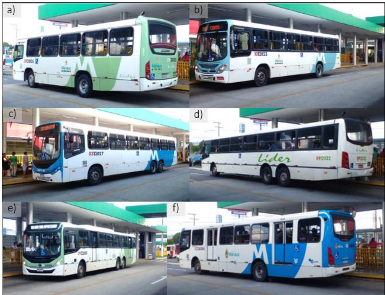
Figura 8 - Tipos de ônibus não articulados: a) midi-ônibus operando em linha alimentadora entre bairros e estação troncal; b) ônibus convencional operando em linha alimentadora entre bairro e estação; c) e d) ônibus de 15 metros operando linha diametral entre bairro, estação e terminal; e) linha troncal com operação de ônibus de 15 metros e com portas para operar em sistema BRS; f) ônibus convencional de linha troncal com portas BRS.
